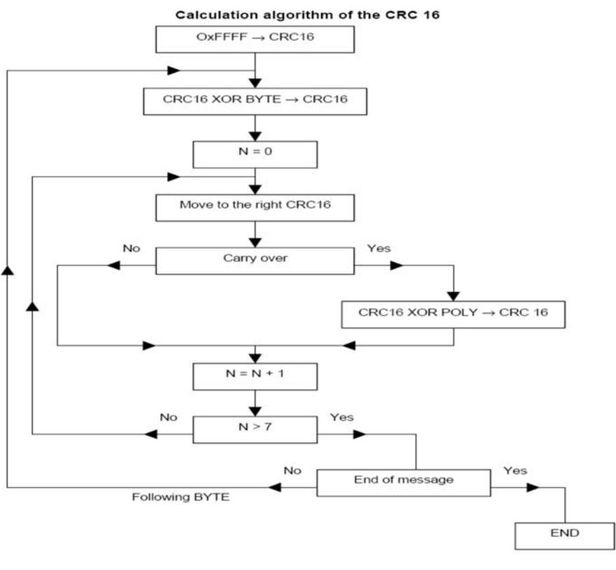
EXEMPLO DE Cálculo de geração do CRC em conformidade com o protocolo Modbus
